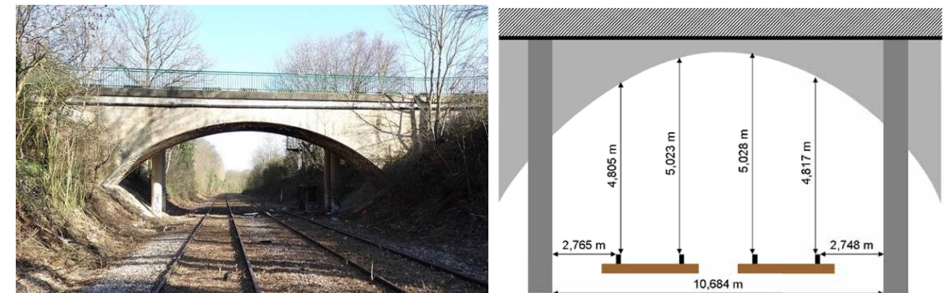
Figure 39 : Vue du pont du chemin des Princes prise vers le Nord et Hauteur disponible sous le chemin des Princes (Source : SNCF Réseau – avril 2015)
